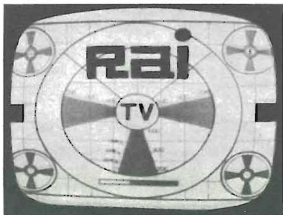
Fig. 6.14. - Come appare il monoscopio quando il controllo di linearità orizzontale non è ben regolato.
