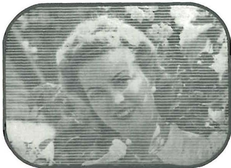
Fig. 5.7. - Immagine televisiva con basso numero di righe; dato il loro numero limitato, le righe risultano ben visibili.
