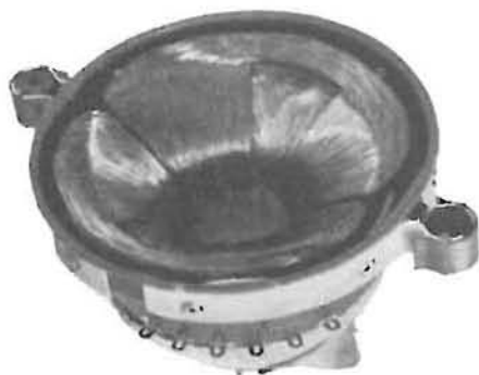
Fig. 3.10. - Giogo di deflessione con le bobine della figura precedente.
