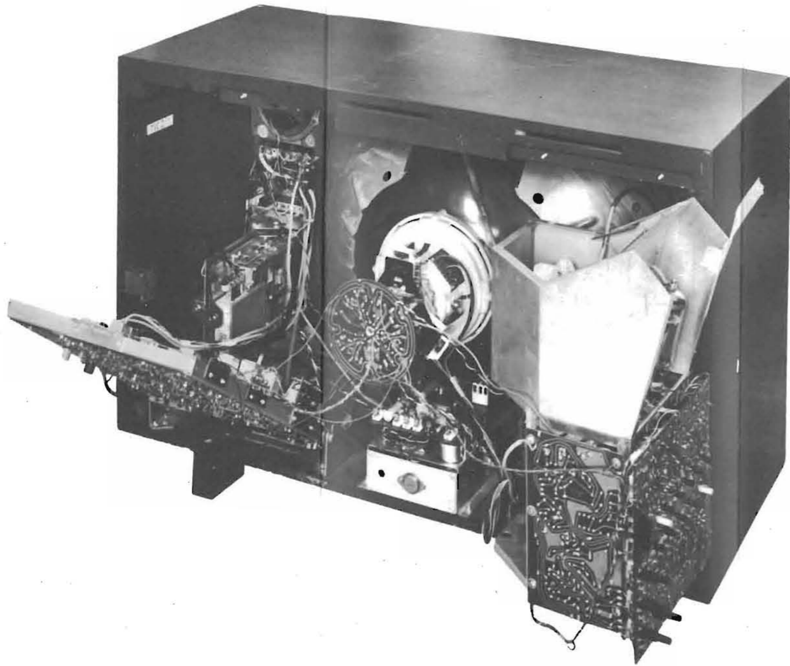
Tavola XXVIII — TELEVISORE A COLORI PHONOLA (FIMI) mod. TV 25 C 76/6 - Quarta parte - A sinistra, nell'interno è visibile il selettore integrato VHF-UHF; al centro, il cinescopio tricromico con il pannello rotondo dei circuiti ausiliari, e sotto di esso l'alimentatore BT; a destra, di fronte
