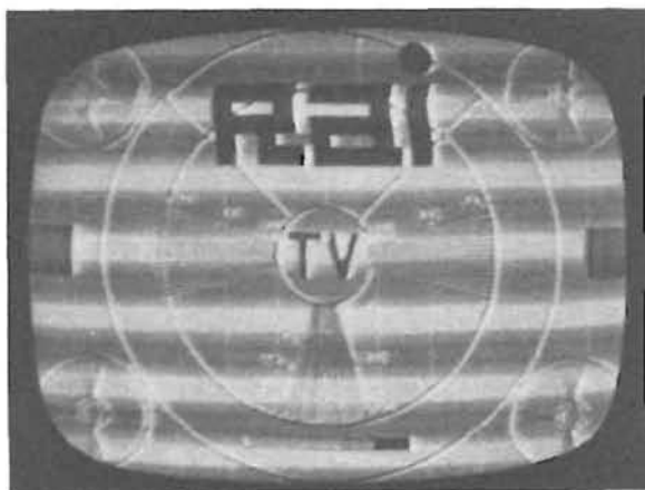
Fig. 6.10. - Barre nere sullo schermo per presenza di "suono nel video", a causa di errata sintonia del televisore.
